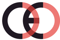
Virheellinen CE-merkki (liian lähellä)
